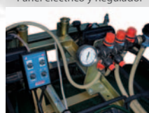
Panel eléctrico y Regulador
