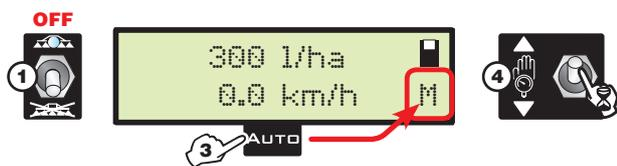
3 Desde la pantalla de trabajo controlar que el funcionamiento manual se encuentre activado (en el display aparece la indicación M). De lo contrario, activarlo presionando la tecla **AUTO**.
